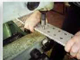
Mandrelling by using ПНП-5,5 press
